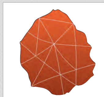
Herkömmlich geformtes Korn mit Bruchkanten.
